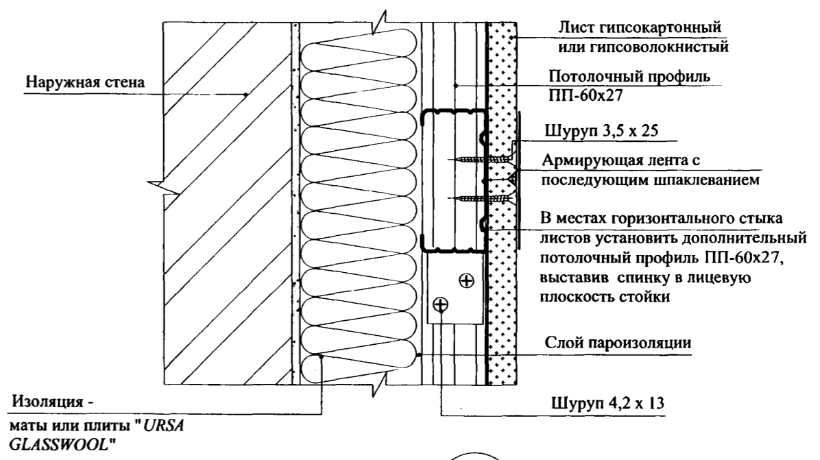
Горизонтальный стык двухслойной обшивки
