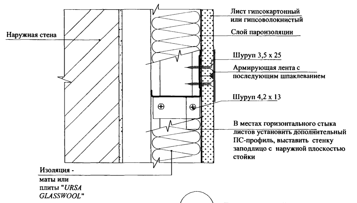
Горизонтальный стык двухслойной обшивки (Horizontal joint of double-layer cladding)
