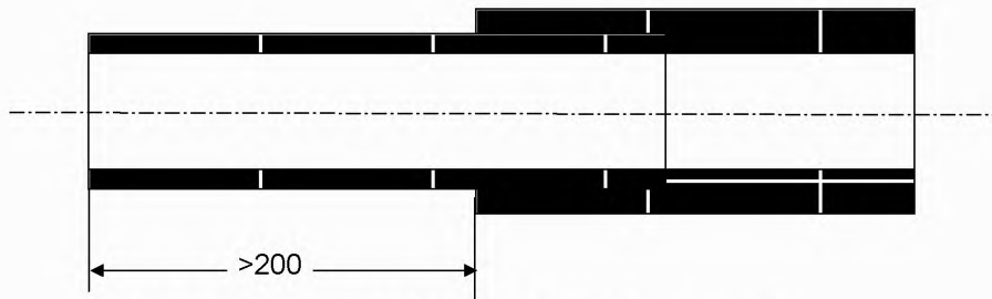
Рис. 8. Контрольное сварное соединение типа Р.
