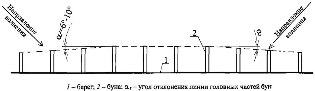
1 – берег; 2 – бунa;  $\alpha_g$  – угол отклонения линии головных частей бун
