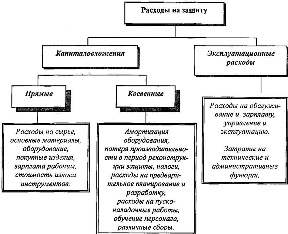
Рис.3. Структура затрат на внедрение защитных мер.
