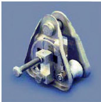
Рис. 5.7. Роликовый зажим SO 181.5. Для проводов сечением 35-120 мм<sup>2</sup>. Момент затяжки болтов 20 Нм.
