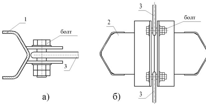
Рис. 2.8. Крепление тяги к стойке опоры
