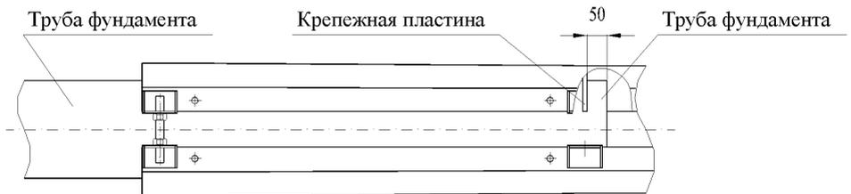
Рис. 2.5. Расположение трубы фундамента в стойке опоры
