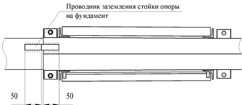
Рис. 2.6. Заземление стойки опоры на трубу фундамента
