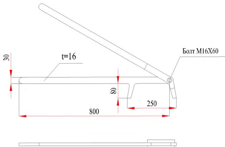
Рис. 2.2. Приспособление для сборки трубы фундамента со стойкой анкерно-угловой и концевой опор
