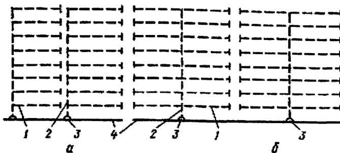
а – одностороннего подсоединения; б – двустороннего подсоединения; 1 – закрытые дрены; 2 – закрытый коллектор; 3 – устье коллектора; 4 – проводящий (магистральный) осушительный канал
