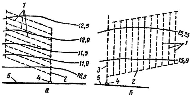
а – поперечная; б – продольная; 1 – закрытые дрены; 2, 3 – закрытые коллекторы различных порядков; 4 – устье коллектора; 5 – проводящий (магистральный) осушительный канал
