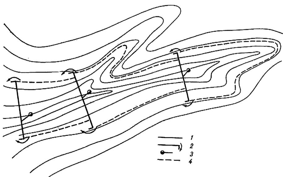
1 – водоудерживающие вали; 2 – водообходы; 3 – сооружения, предназначенные для опорожнения ярусов глубокого затопления; 4 – границы затопления
