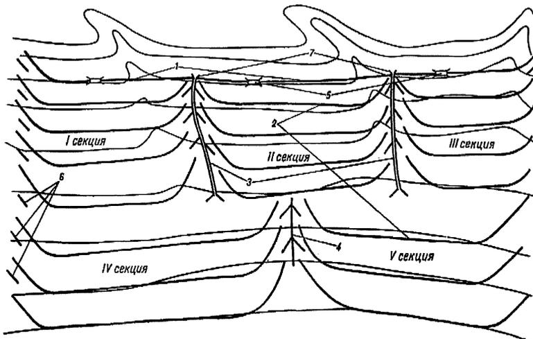
1 – вал распределительного яруса; 2 – вододерживающие валы ярусов; 3 – распределительные каналы; 4 – направляющие валики; 5 – водосливы автоматы; 6 – водообходы; 7 – водозаборные водосливы; I–V – секции лиманов
