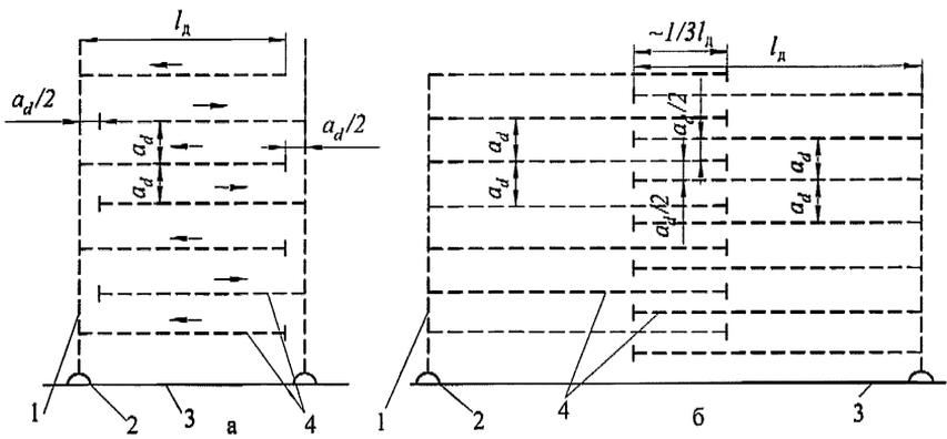
*а* – поочередное подключение дрен к соседним коллекторам; *б* – сгущенное расположение истоковых участков дрен; 1 – закрытый коллектор; 2 – устье коллектора; 3 – проводящий (магистральный) осушительный канал; 4 – закрытые дрены;  $a_d$  – расстояние между дренами;  $l_d$  – длина дрены
