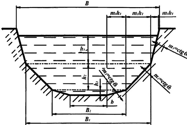
$b$  – ширина канала по дну,  $B$  – ширина по верху,  $B_1$  – ширина канала у подножья верхних откосов, м;  $B_2$  – ширина канала у подножья средних откосов;  $h_1$  – глубина верхней части канала без учета запаса превышения бровки над уровнем воды, м;  $h_2$  – глубина средней части канала, м;  $h_3$  – глубина донной части канала, м;  $m_1$  – заложение верхних откосов;  $m_2$  – заложение средних откосов;  $m_3$  – заложение донных откосов.
