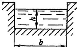
$b$  – ширина канала по дну,  $h$  – глубина воды в канале
