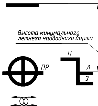
Рис. 3.1.4-2. Грузовая марка судов с минимальным надводным бортом
