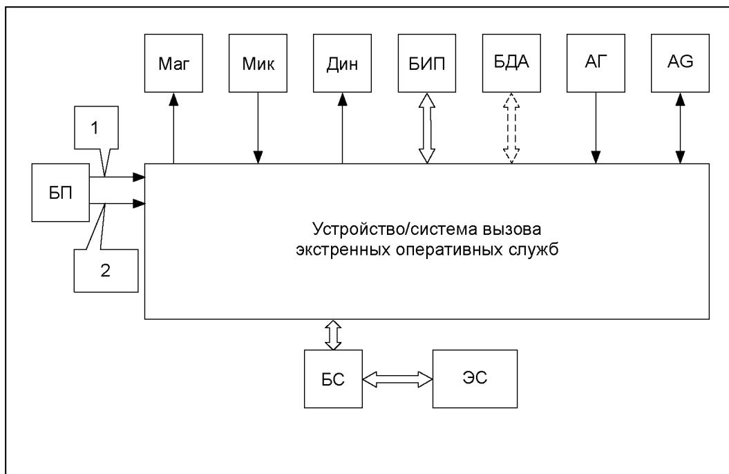
Рисунок А.1 — Схема подключения УСВ в конфигурации дополнительного оборудования
