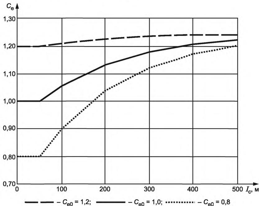
Рисунок 2 — Коэффициент  $C_e$  как функция эффективной длины покрытия  $l_c$
