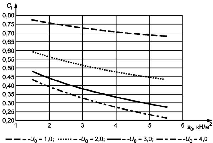
Рисунок D.3 — Термический коэффициент  $C_t$  при  $\theta = 18^\circ\text{C}$
