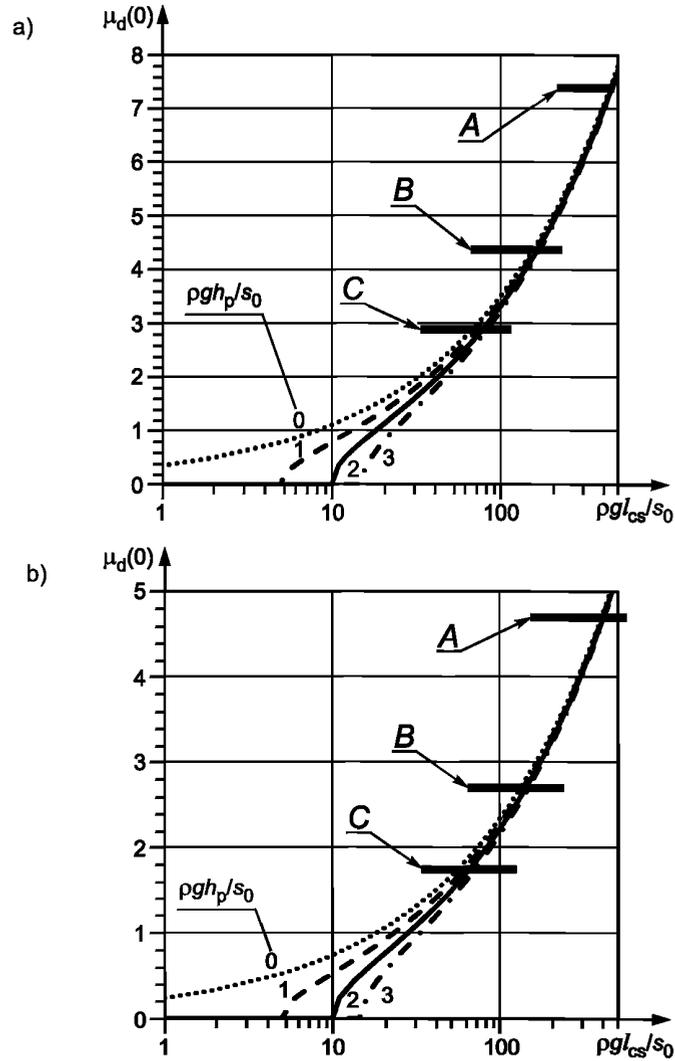
A — верхний предел при  $C_e = 0,8$ ; B — верхний предел при  $C_e = 1,0$ ; C — верхний предел при  $C_e = 1,2$
