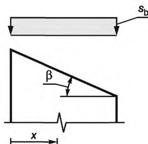
Рисунок В.3 — Распределение снеговой нагрузки для односкатного покрытия
