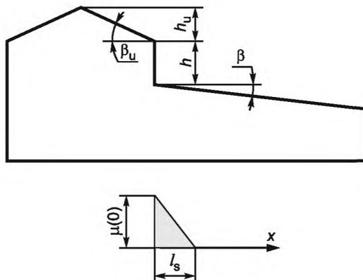
Рисунок В.12 — Коэффициент сползания снеговой нагрузки
