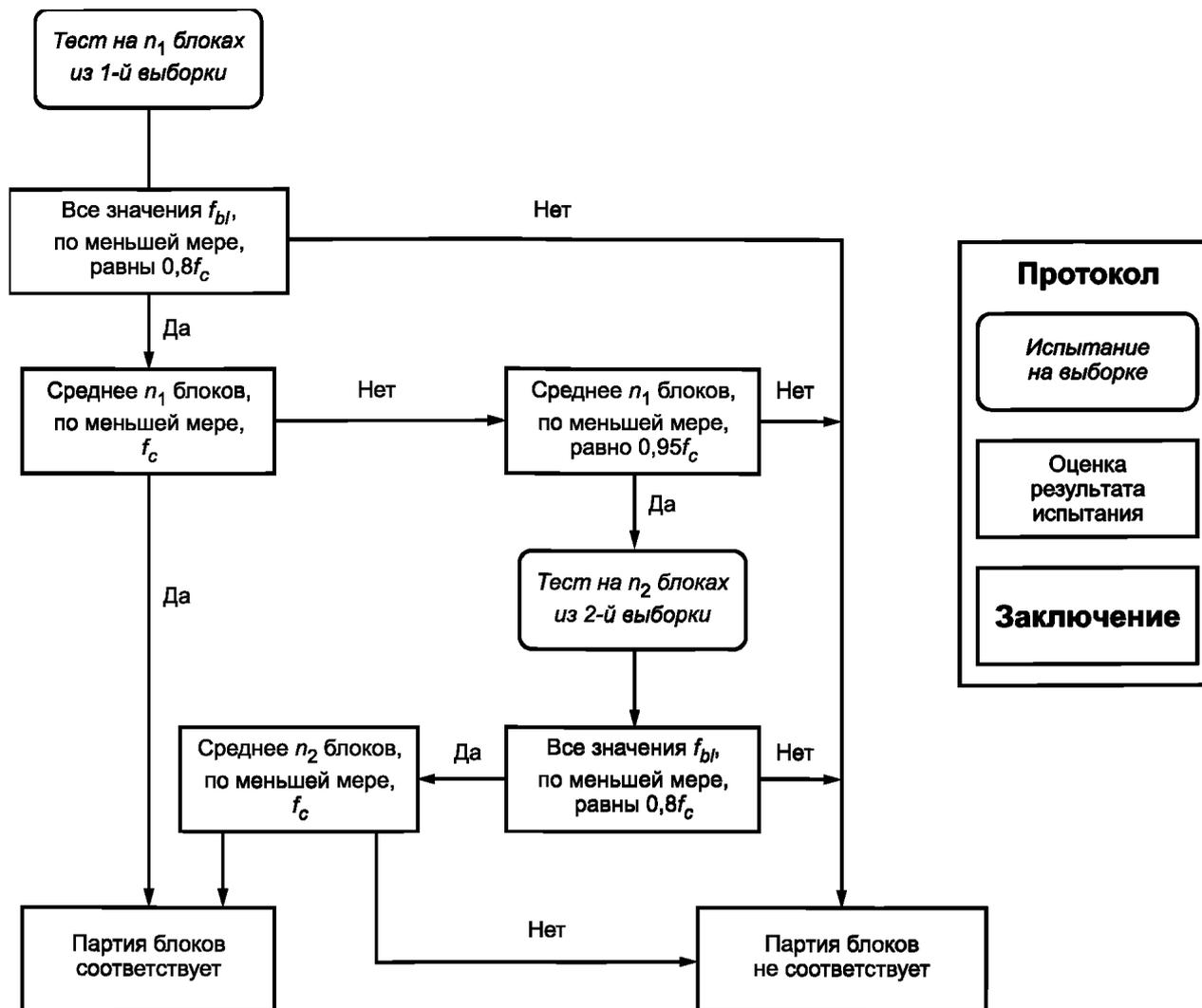
$f_c$  — декларированная средняя прочность или предел прочности при изгибе, МПа (Н/мм<sup>2</sup>);
