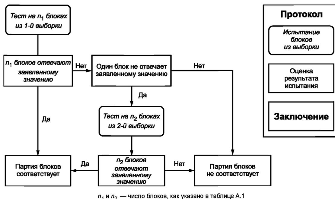
Рисунок В.1 — Методика оценки измерений размеров и капиллярного подсоса воды для блоков
