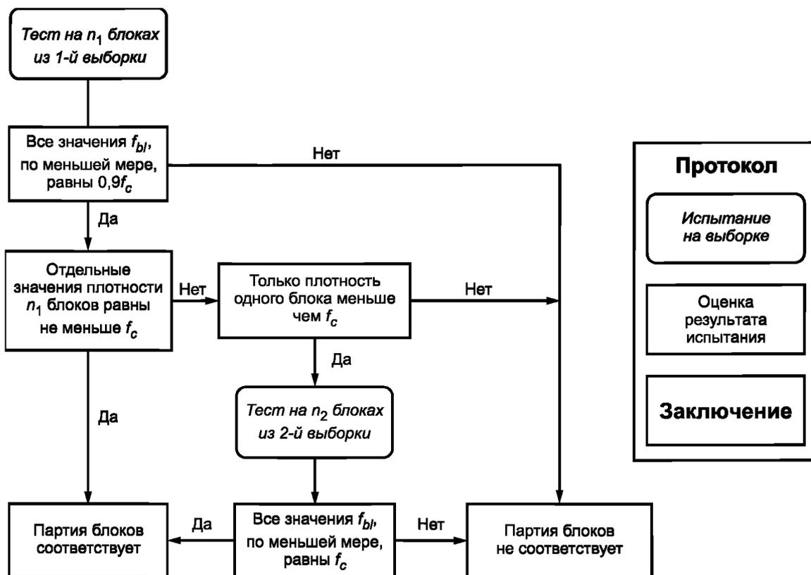
$f_c$  — декларированная характеристическая прочность при сжатии, МПа (Н/мм<sup>2</sup>);
