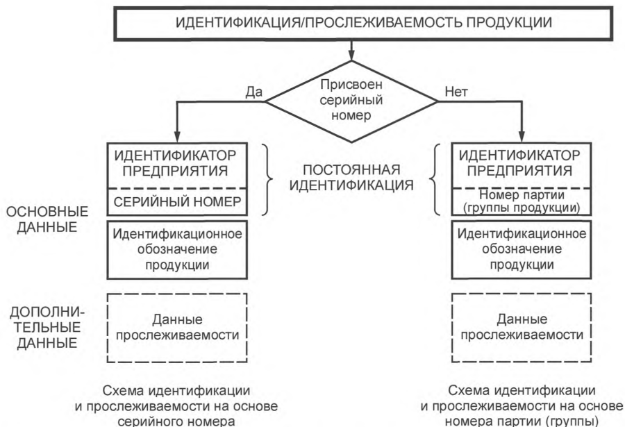
Рисунок 1 — Дерево принятия решений при выборе схемы идентификации и прослеживаемости продукции/изделий
