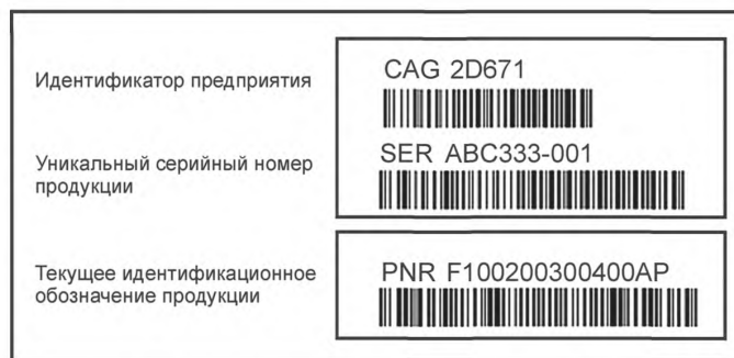
а) Данные, кодированные в формате Code 128 с добавлением визуального представления данных
