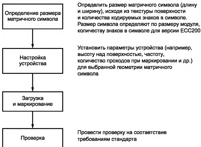
Рисунок 10 — Блок-схема определения параметров маркирования лазером
