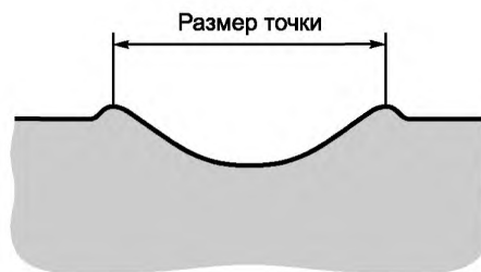
Рисунок 7 — Схема определения размера точки
