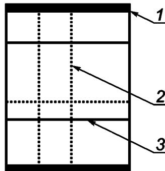
1 — электроды полуфабриката, полученные путем вжигания серебра; 2 — направление поляризации;
