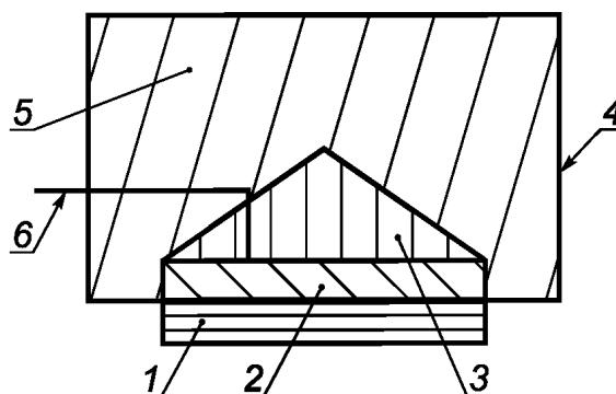
1 — пьезопластинка; 2 — контактный слой; 3 — механический демпфер; 4 — металлический экран; 5 — компауд;
