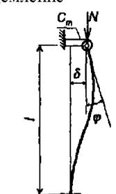
$\mu = \sqrt{\frac{n + 4}{n + 1}}$ $2,0 \geq \mu \geq 1,0$ <p style="text-align: center;">Ж</p> | <p>Верхний конец: Жесткая горизонтальная связь. Угол поворота разрешен с упругой связью. Нижний конец - защемление</p>
