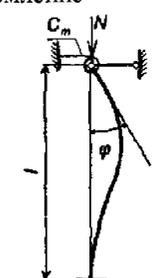
$\mu = 0,5 \sqrt{\frac{n + 4,8}{n + 2,4}}$ $0,7 \geq \mu \geq 0,5$ <p style="text-align: center;">З</p> |
