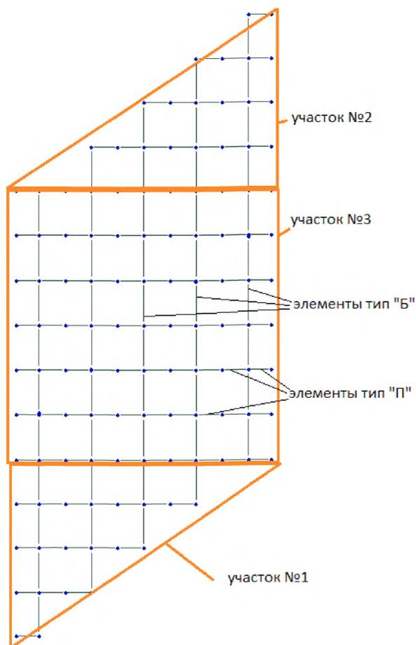
Рисунок Б.3.1 – Схема к формированию расчетной модели косоугольного строения по алгоритму «Б»
