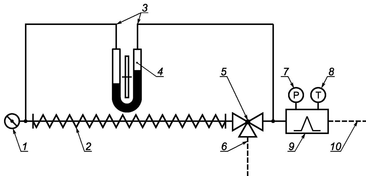
1 — газоотборный зонд; 2 — обогреваемая линия отбора проб; 3 — линия контроля перепада давления в линии отбора проб;
