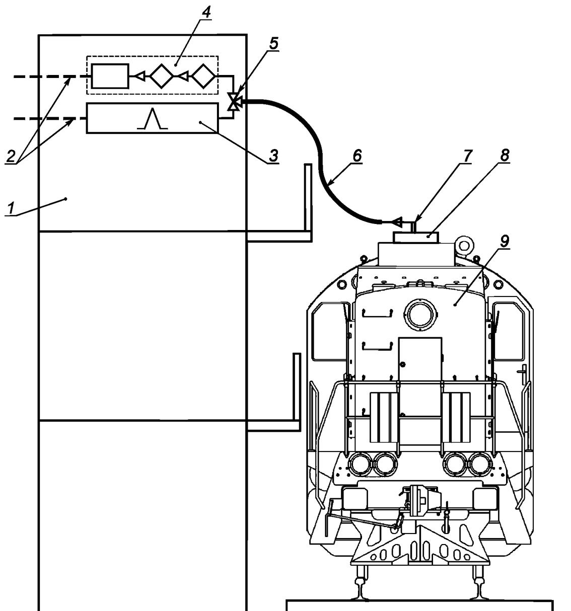
1 — установка измерительного оборудования; 2 — линии дренажа от газоанализатора и дымомера; 3 — дымомер;
