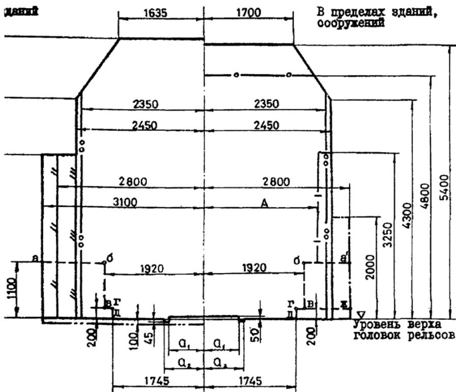
$\alpha_1 = 670$  мм,  $\alpha_2 = 760$  мм - для колес I520 мм;
