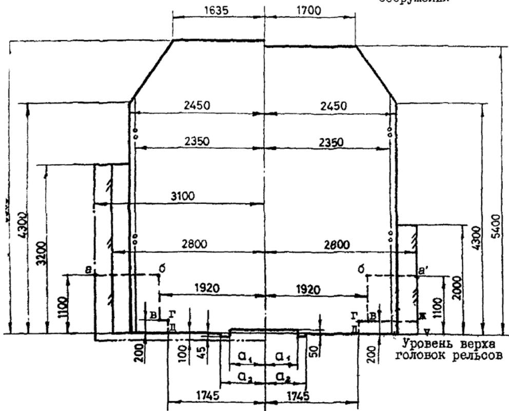
$a_1 = 670 \text{ мм}, a_1' = 760 \text{ мм}$  - для колеи 1520 мм;
