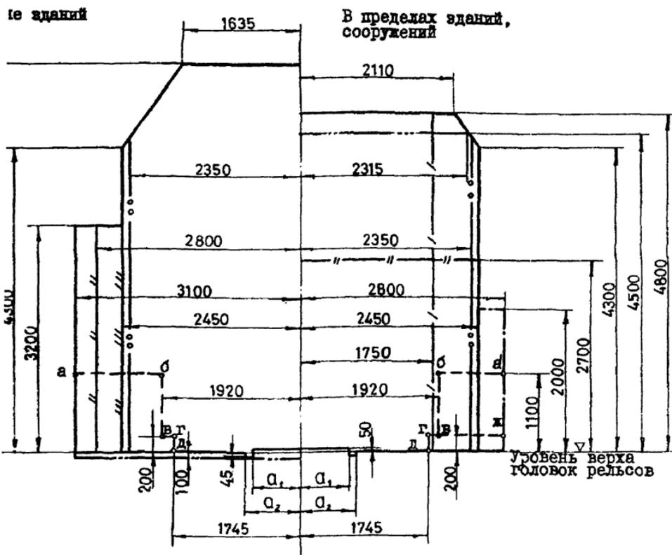
$a_1 = 670$  мм,  $a_2 = 760$  мм - для колеи 1520 мм;
