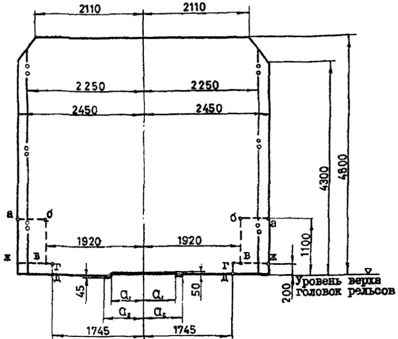
$a_1 = 670 \text{ мм}, a_2 = 760 \text{ мм}$  - для колес 1520 мм;
