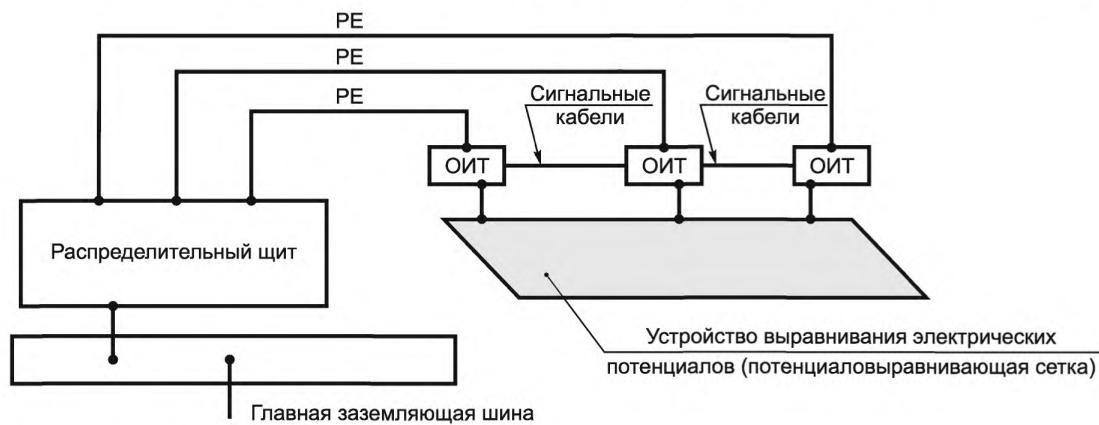
**01-12-14 главный заземляющий зажим (шина) (main earthing terminal main earthing busbar main grounding terminal (US) main grounding busbar (US)):** Зажим (шина), являющийся (аяся) частью заземляющего устройства установки и обеспечивающий (ая) присоединение нескольких проводников с целью заземления [ГОСТ Р МЭК 60050-195—2005, ГОСТ Р МЭК 60050-826—2009, ГОСТ Р 50571.5.54—2013/МЭК 60364-5-54:2011].
