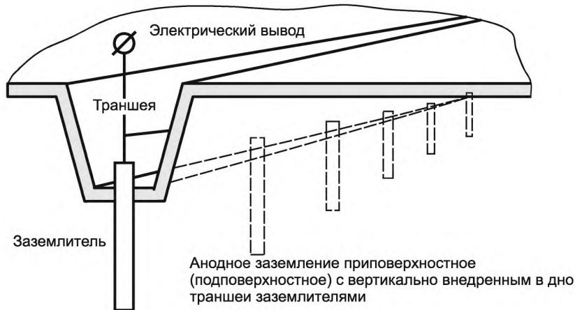
**01-12-05 анодное заземление свайное:** Заземление, выполненное из стальных свай.
