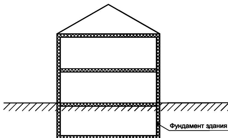
**01-10-08 заглубленный в грунт фундаментный заземлитель (soil-embedded foundation earth electrode):** Заземляющий электрод, как правило, в виде замкнутого контура, заглубленный в грунт под фундаментом здания [МЭК 60050-826:2004, статья 826-13-08, Изм., ГОСТ Р 50571.5.54—2013/МЭК 60364-5-54:2011], [1].
