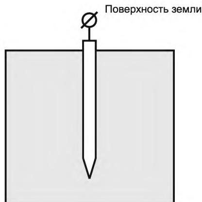
**01-12-06 анодный заземлитель графито-пластовый:** Заземлитель, выполненный из порошка — углеродграфита, скрепленного связующим материалом — термореактивной смолой.
