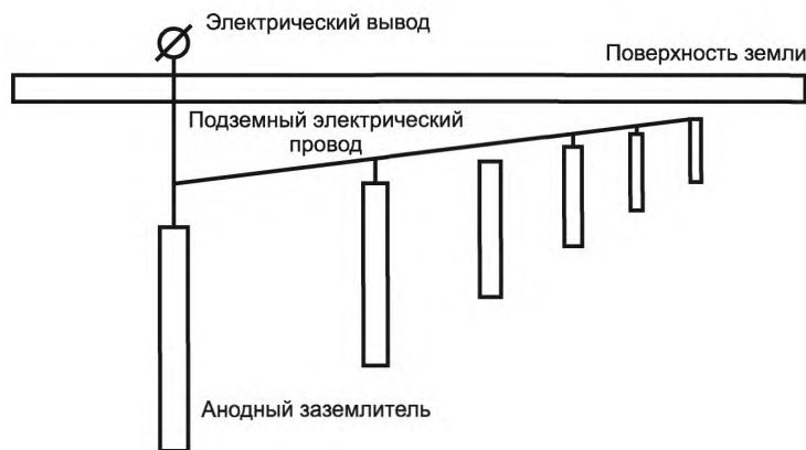
**01-11-02 анодный заземлитель:** Элемент анодного заземления, осуществляющий непосредственный контакт с коррозионной средой.
