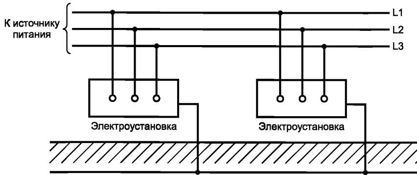
**01-10-10 заземление на землю:** Формирование замкнутой цепи для отвода аномально высокого напряжения и опасных ближдающих и иных токов непосредственно в окружающую токопроводящую конструкцию, электролитическую среду.
