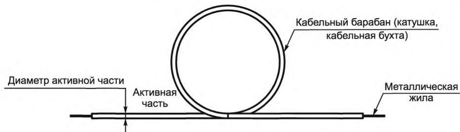
**01-12-10 анодный заземлитель протяженный гибкий:** Заземлитель, выполненный из электропроводного полимерного материала, отношение активной части которого к ее поперечному размеру превышает 10 000, а активная часть выдерживает знакопеременный изгиб в количестве не менее 20 циклов, без изменения электрофизических свойств.
