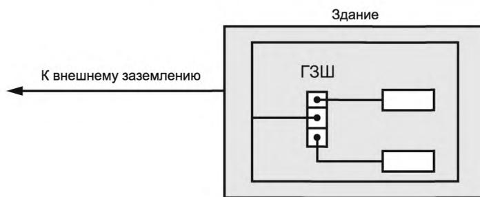
**01-11-05 глухозаземленная нейтраль:** Нейтраль трансформатора или генератора в сетях трехфазного тока, вывод источника однофазного тока, средняя точка в трехпроводных сетях постоянного тока напряжением до 1 кВ, присоединенная к заземляющему устройству непосредственно.
