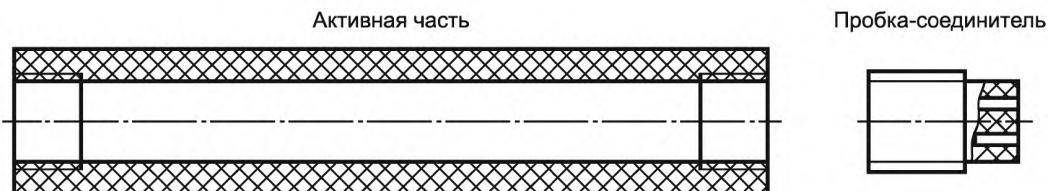
**01-12-07 анодный заземлитель локальный:** Дискретный заземлитель из электропроводного материала, с заданными размерами токоотдающей части.
