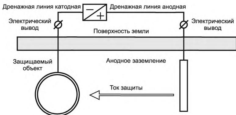
**01-12-28 защита электрохимическая:** Технологическая операция по предупреждению интенсивного коррозионного воздействия на металлические токопроводящие конструкции окружающей их электролитической среды.
