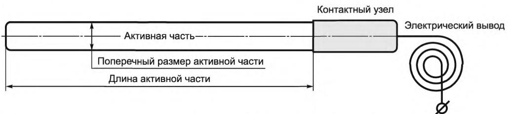
**01-12-03 анодное заземление модульное:** Сосредоточенное заземление, состоящее из локальных заземлителей с горизонтальным, вертикальным или комбинированным расположением, соединенных между собой определенным образом.
