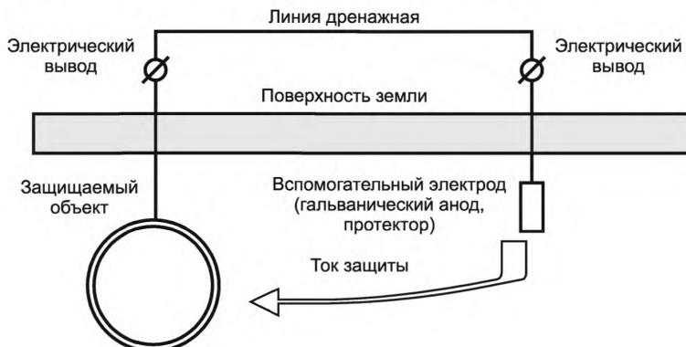
**01-12-27 защита катодная от отдельного источника тока:** Электрохимическая защита, при которой защитный ток вырабатывается внешним источником энергии.
