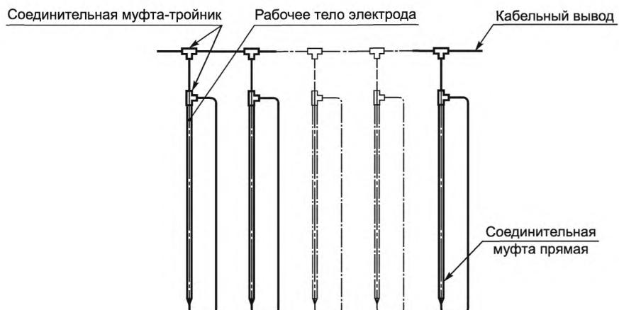
**01-12-04 анодное заземление поверхностное (приповерхностное, подповерхностное):** Заземление, единичные заземлители которого укладываются на дно траншеи либо внедряются в ее дно.
