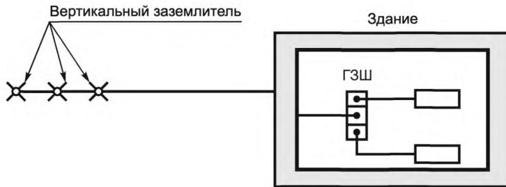
**01-12-13 выравнивание потенциала:** Снижение разности потенциалов между заземляющим устройством и поверхностью земли путем электрического соединения его с уложенными в земле защитными проводниками [5].
