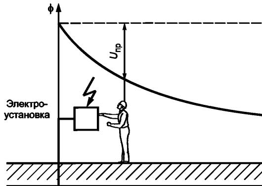
**01-13-31 напряжение шага:** Напряжение между двумя точками на поверхности земли, на расстоянии 1м одна от другой, которое принимается равным длине шага человека.
