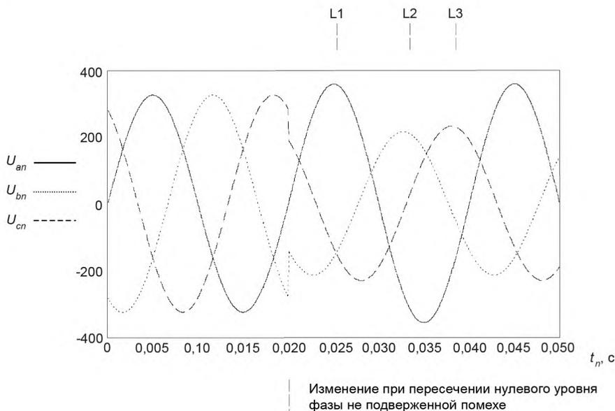
Рисунок 1 — Пример несимметричного трехфазного напряжения питания (испытание 3)
