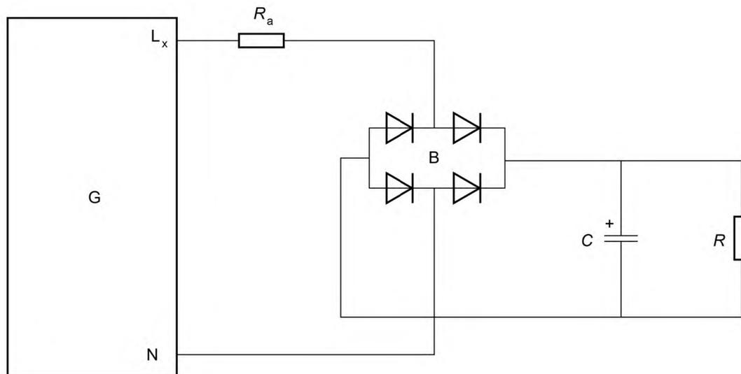
$G$  — испытательный генератор;  $L_x$  — вывод фазного напряжения;  $N$  — нейтраль;  $B$  — мостовой выпрямитель;  $C$  — электролитический конденсатор  $11000 \text{ мкФ} \pm 20\%$ ;  $R$  — резистор  $61 \text{ Ом} \pm 1\%$ ;  $R_a$  — дополнительный резистор
