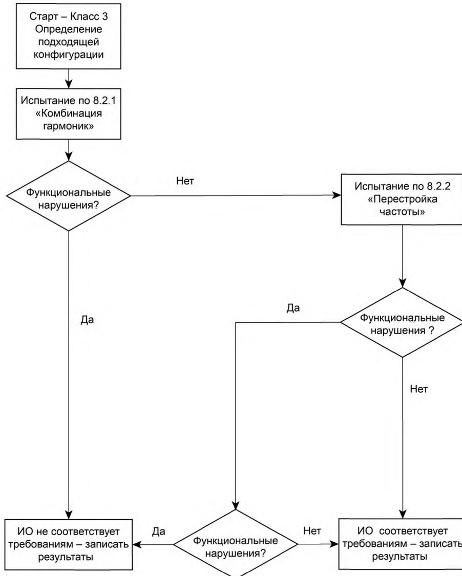
Рисунок 1b — Алгоритм проведения испытаний для класса электромагнитной обстановки 3
