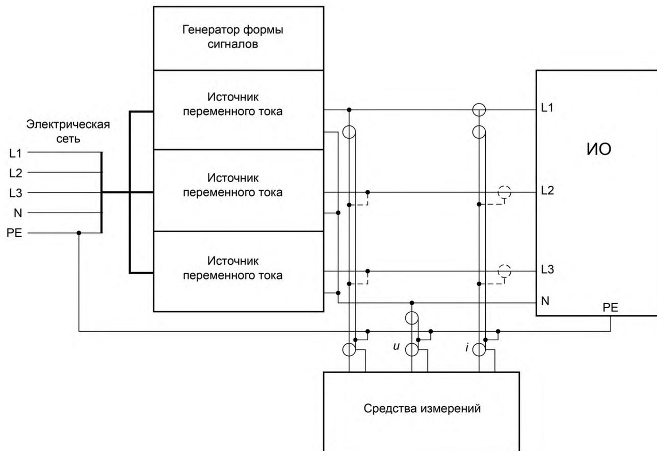
Рисунок 3 — Пример испытательной установки для трехфазной сети
