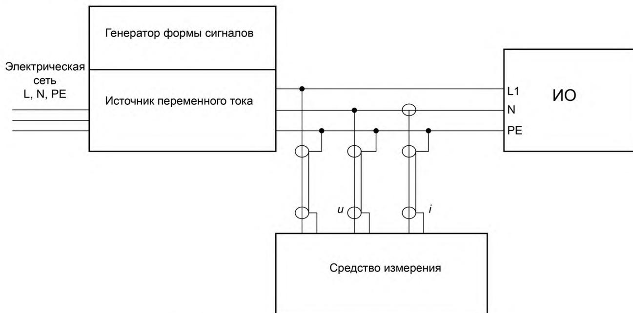
Рисунок 2 — Пример испытательной установки для однофазной сети
