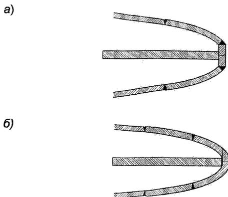
Рис. 3.10.2.6.2-1 Примеры комбинированного (а) и листового (б) форштевней
