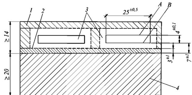
Рис. 4.8.3.6.2 Схема вырезки образцов при испытаниях наплавленного металла на стойкость против МКК:
