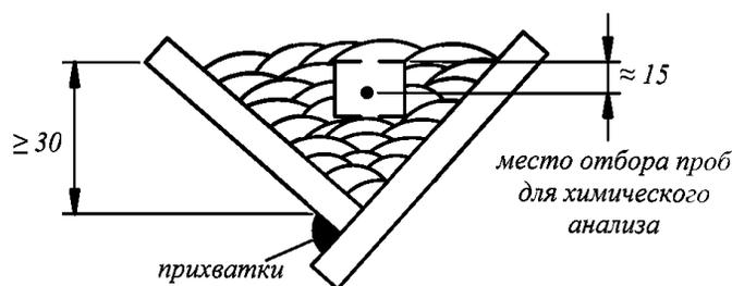
Рис. 4.9.2 Проба для испытаний наплавленного металла
