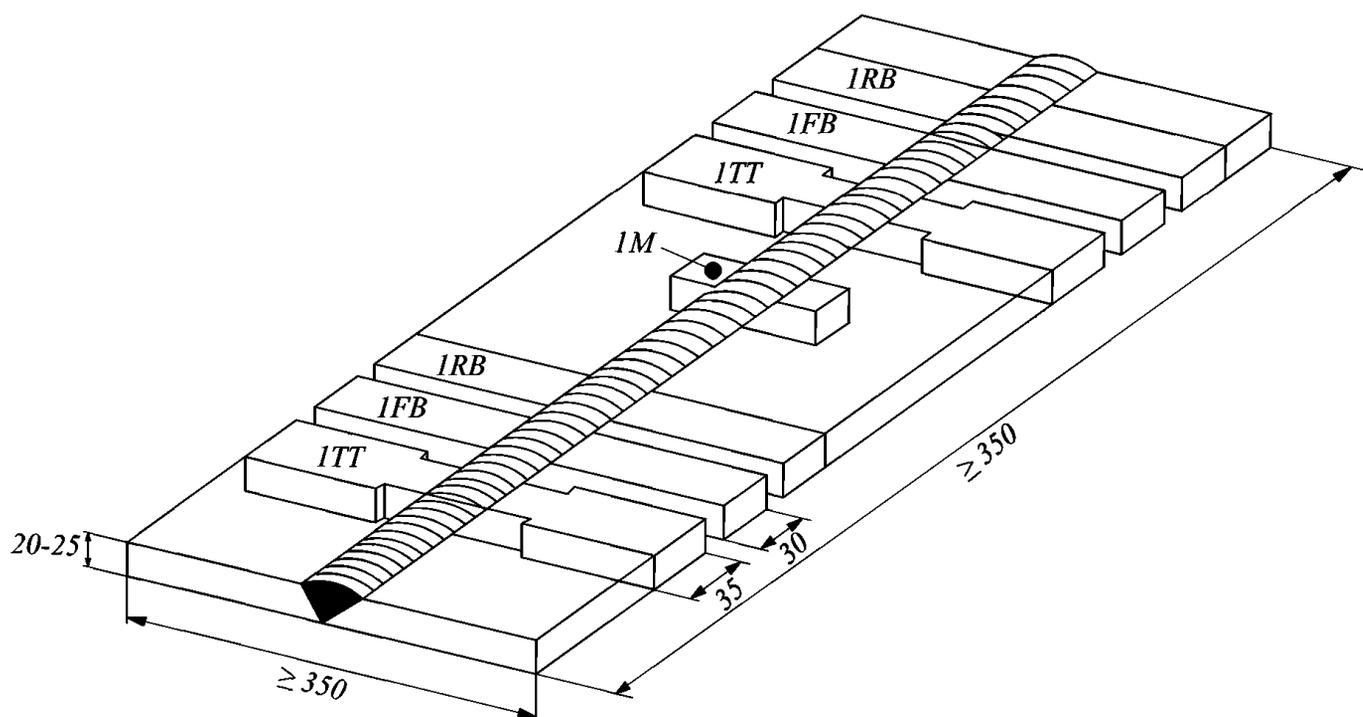
Рис. 4.9.3.1-2 Дополнительная проба стыкового соединения для сварки в нижнем пространственном положении: разделка кромок должна быть односторонней V-образной с углом раскрытия  $70^\circ$ ; допускается выполнение обратных уплотняющих (подварочных) проходов; обозначения образцов должны соответствовать требованиям 4.9.3.5
