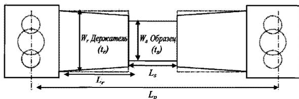
Рис. 3.20.6.2 Схема расположения испытываемого образца, держателя и оснастки
