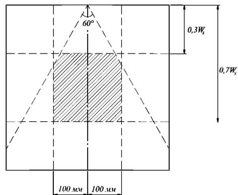
Рис. 3.20.6.9.2.1 Необходимые условия расположения точки торможения трещины
