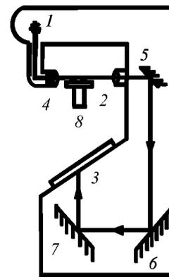
Рис. 2.5.7.2 Прибор, рекомендуемый для определения краевого угла смачивания:
