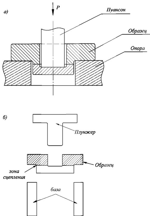
Рис. 5.3.2.3.4.3.2-1 Схемы испытания на отрыв (а или б)
