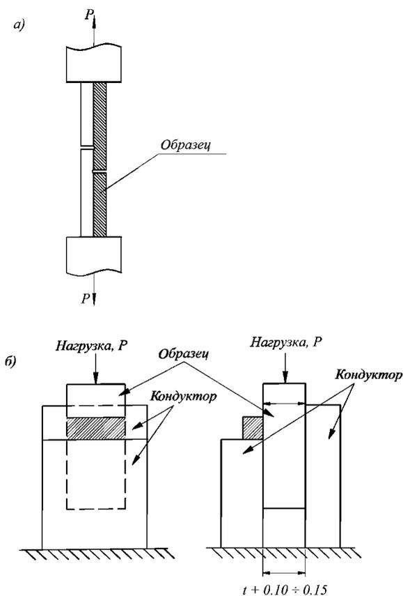
Рис. 5.3.2.3.4.3.2-2 Схемы испытания на срез (а или б)
