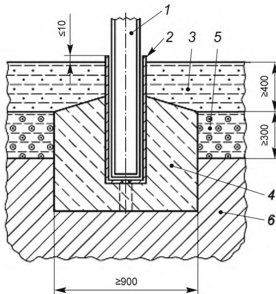
1 — стойка; 2 — установочная гильза; 3 — слой песка; 4 — бетонный фундамент; 5 — дренажный слой (щебень);
