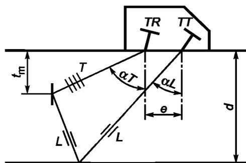
$TT$  — излучающий активный элемент;  $TR$  — принимающий активный элемент;  $e$  — расстояние между точками выхода активных элементов;  $d$  — толщина материала;  $t_m$  — контролируемая глубина точки пересечения;  $L$  — путь продольной волны;  $T$  — путь поперечной волны
