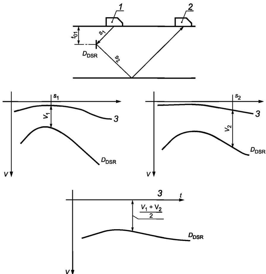
$D_{DSR}$  — диаметр плоскодонного отражателя;  $s$  — длина пути звука;  $f$  — глубина дефекта от сканируемой поверхности;  $V$  — изменение усиления; 1, 2 — преобразователи №№ 1, 2; 3 — донная поверхность
