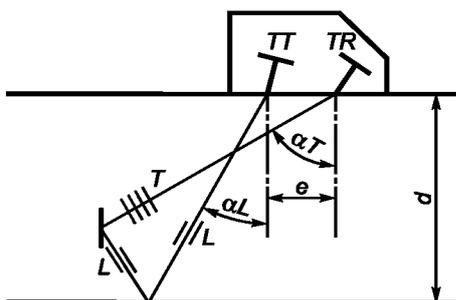
$TT$  — излучающий активный элемент;  $TR$  — принимающий активный элемент;  $e$  — расстояние между точками выхода активных элементов;  $d$  — толщина материала;  $L$  — путь продольной волны;  $T$  — путь поперечной волны
