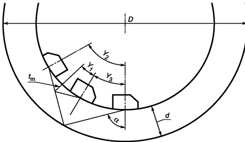
$D$  — наружный диаметр;  $d$  — толщина материала;  $t_m$  — контролируемая глубина точки пересечения
