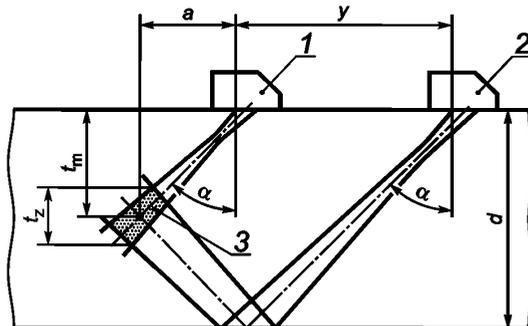
1 — преобразователь № 1; 2 — преобразователь № 2; 3 — зона контроля;  $a$  — проекция расстояния;  $d$  — толщина материала;  $t_m$  — контролируемая глубина точки пересечения;  $y$  — расстояние между преобразователями;  $t_z$  — высота контролируемой зоны
