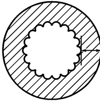
Рисунок А.3 — Измерение толщины изоляции (многопроволочная жила)
