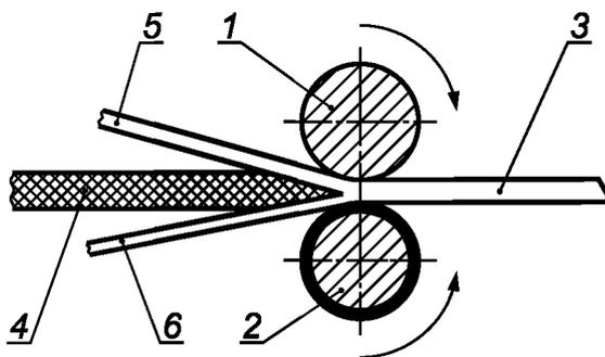
1 — ролик стальной, с проточками; 2 — ролик стальной обрешиненный; 3 — полоска; 4 — нож, стационарно закрепленный или способный перемещаться; 5 — часть полоски, из которой вырезают образцы; 6 — часть полоски, которая идет в отходы
