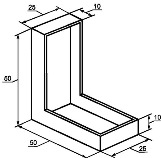
Рисунок 1 — Угловой бокс с двумя прямоугольными ящиками
