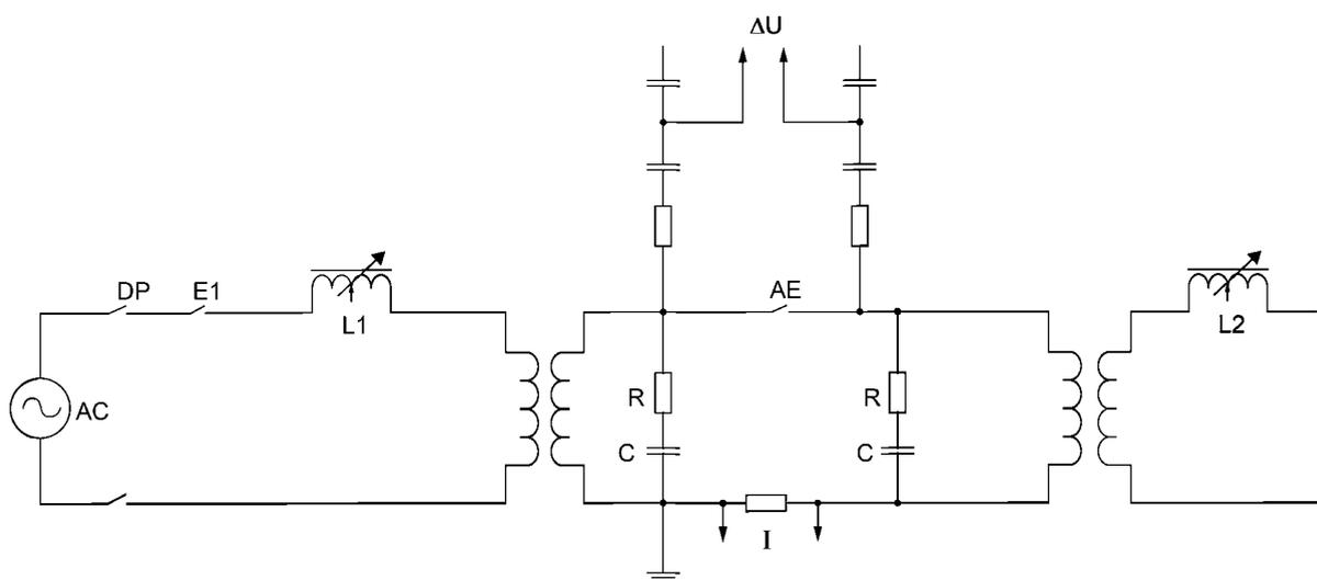
Рисунок А.1 — Принципиальная схема для испытаний выключателя переменного тока
