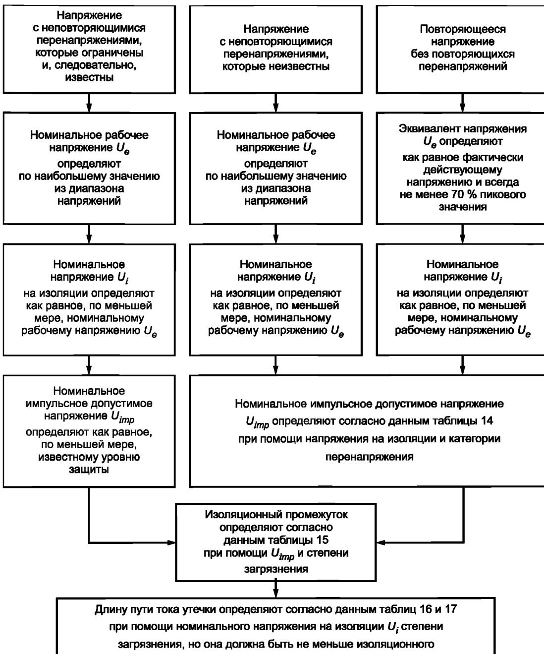
Рисунок А.1 — Определение изоляционного промежутка и длины пути тока
