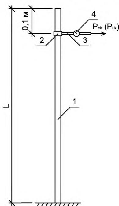
1 — опора; 2 — хомут; 3 — стальной канат; 4 — динамометр;  $L$  — длина опоры;  $P_{yk}$  — контрольная испытательная нагрузка при испытании на жесткость;  $P_{uk}$  — контрольная испытательная нагрузка при испытании на прочность
