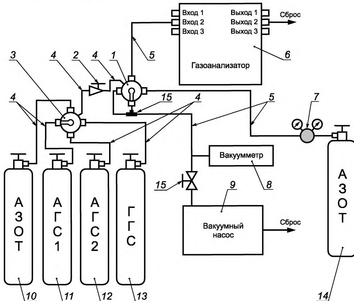
1, 3 — краник пятиходовый; 2 — вентиль тонкой регулировки; 4 — трубы из нержавеющей стали 6х3 мм; 5 — трубы фторопластовые 6х4 мм; 6 — газоанализатор (вид сверху); 7 — редуктор; 8 — вакуумметр; 9 — вакуумный насос; 10 — баллон с нулевым газом (азотом); 11 — баллон с анализируемой газовой смесью № 1; 12 — баллон с анализируемой газовой смесью № 2; 13 — баллон с градуировочной газовой смесью; 14 — баллон со вспомогательным (продувочным) азотом
