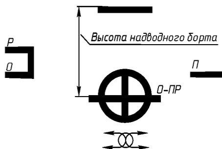
Рис. 5.3.6 Грузовая марка на судах класса «О-ПР»
