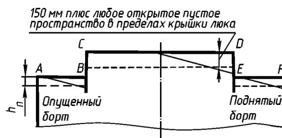
Рис. ПЗ.1.8-1. Распределение пустот в плоскости поперечных сечений отсеков, когда часть отсека в пределах длины люковых вырезов не имеет продольной переборки
