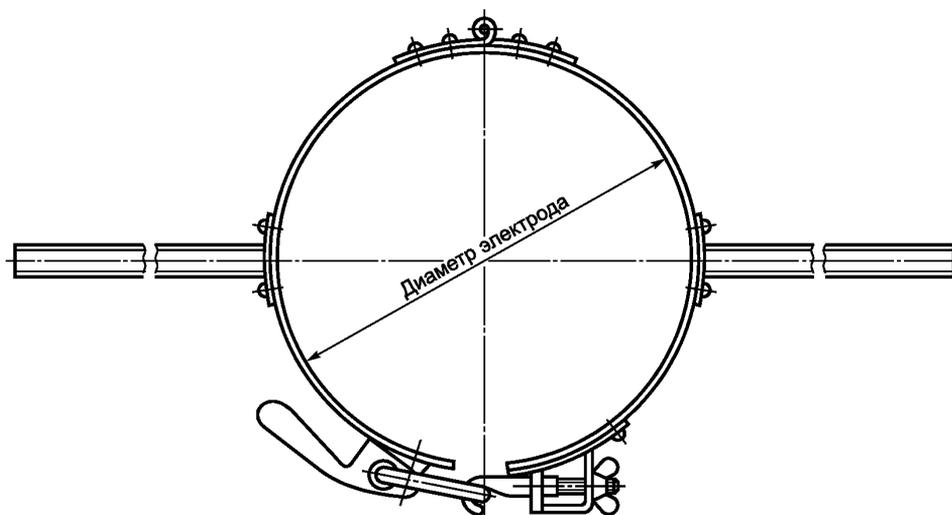
Рисунок 10 — Ручной зажим без ограничителя вращающего момента
