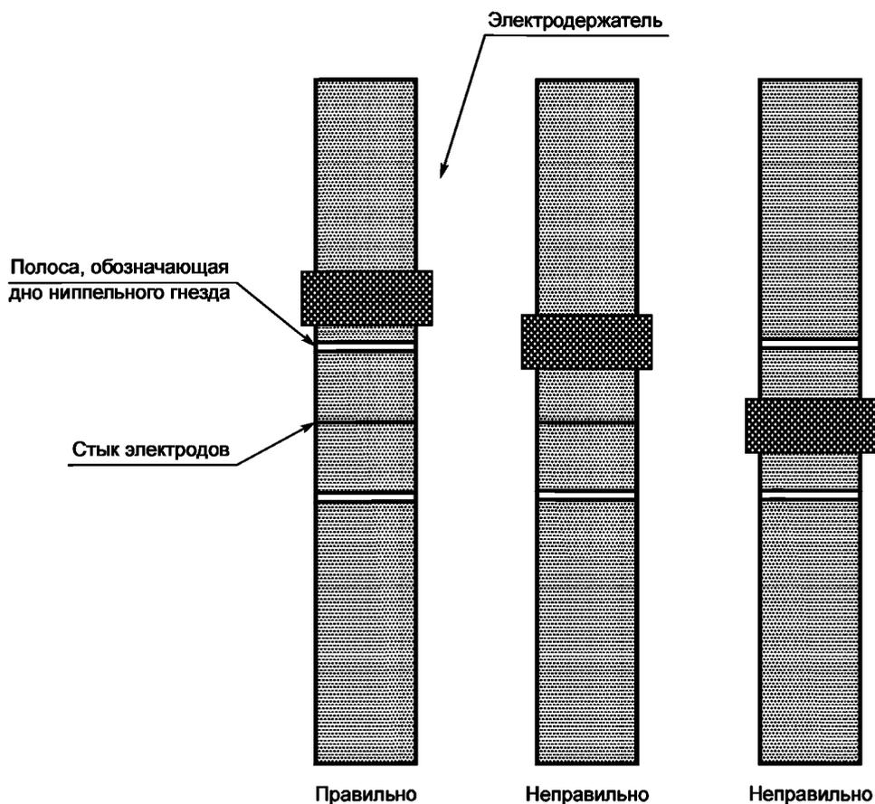
Рисунок 11 — Схема зажима электродов в электродержателе
