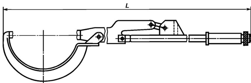
Рисунок 9 — Ручной зажим с ограничителем вращающего момента
