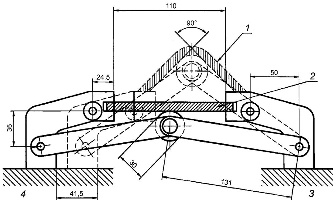
1 — образец в положении максимального изгиба; 2 — образец в положении нулевого изгиба; 3 — неподвижная опора;
