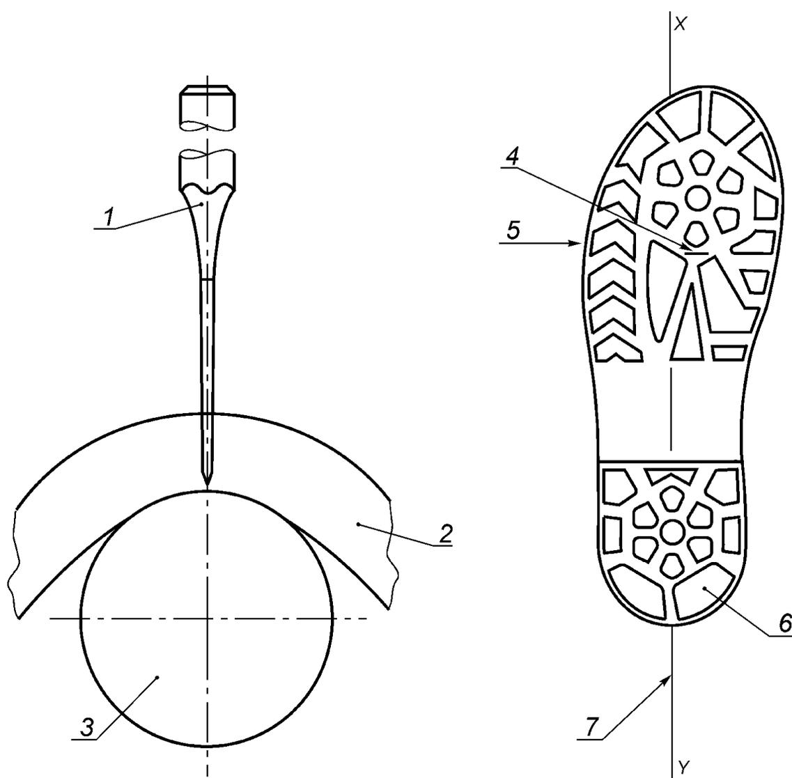
1 — режущий инструмент; 2 — образец; 3 — оправка испытательной машины; 4 — одиночный надрез, параллельный линии максимального напряжения; 5 — линия максимального напряжения (деформации) AC; 6 — выступы протектора; 7 — продольная ось XY
