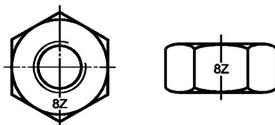
Рисунок 1 — Пример маркировки горячеоцинкованных гаек с завышенной резьбой поля допуска 6AZ после нанесения покрытия
