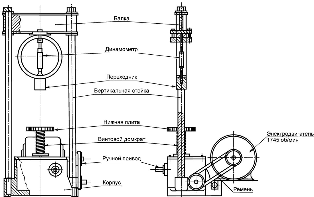
Рисунок 2 — Схема испытательной установки
