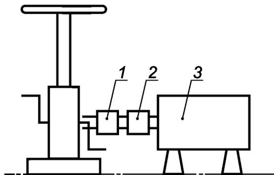
1 — датчик крутящего момента; 2 — датчик скорости; 3 — мотор
