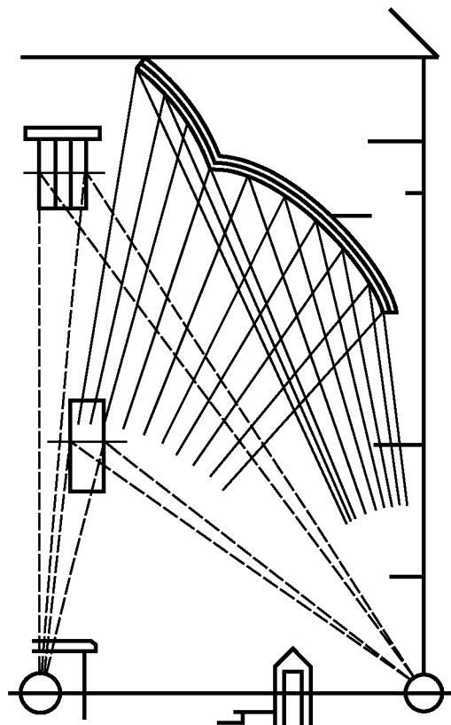
Рисунок Б.4 — Схема обмера арки от двух точек
