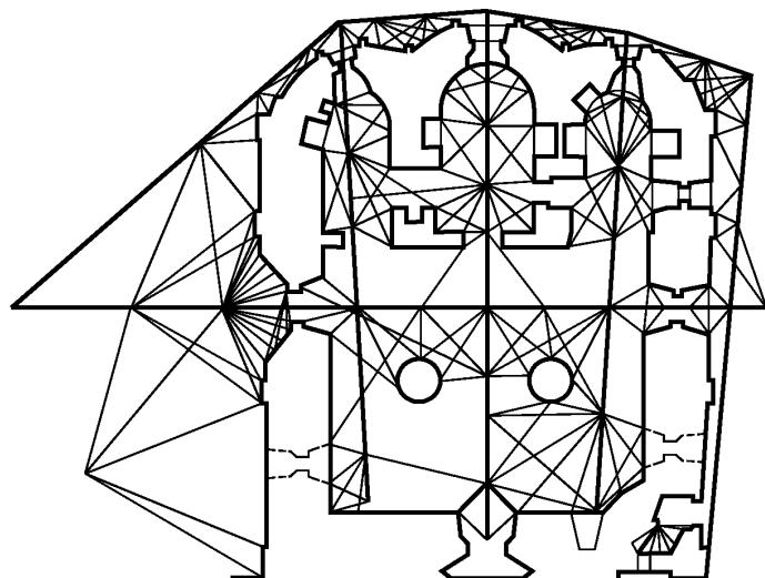
Рисунок Б.2 — Схема обмера плана с причалками
