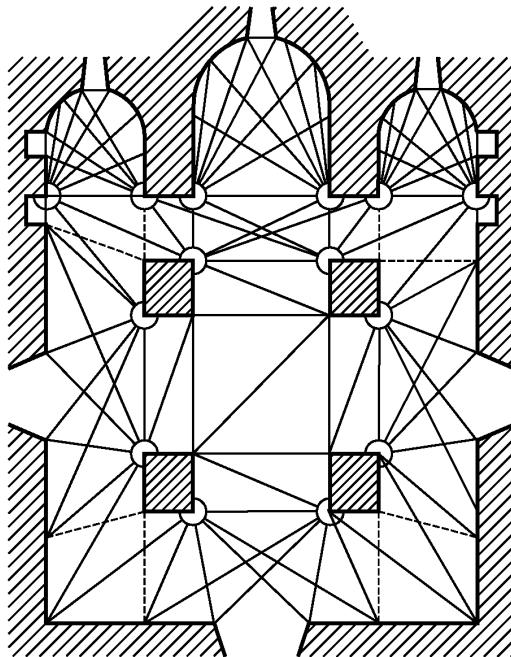
Рисунок Б.1 — Схема обмера плана методом триангуляции
