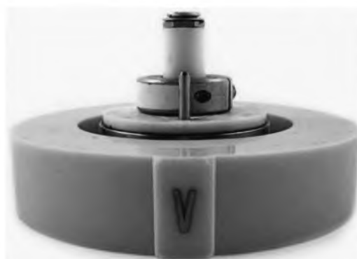
Рисунок 6 — Кольцо устройства для растрескивания битумного вяжущего в сборе с силиконовой формой
