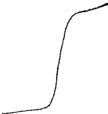
Рис. Полярографическая волна восстановления цинка в хлоридно-аммиачном растворе. Концентрация цинка 15 мкг/мл
