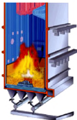
Рисунок 2.10 — Топка с кипящим слоем [11]
