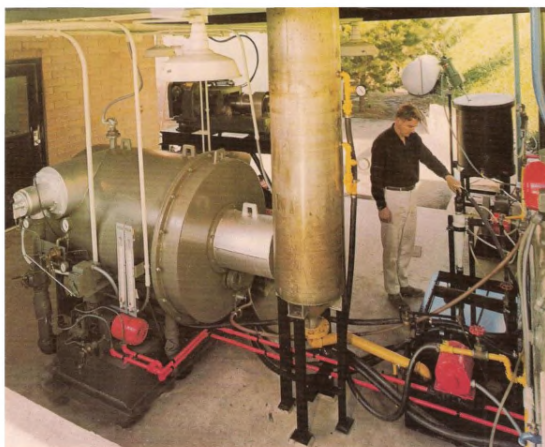
Рисунок 2.9 — Горизонтальный циклонный реактор для термического обезвреживания шламов [19]
