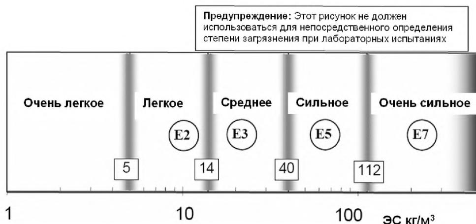
Рисунок 3 — Взаимосвязь между измерениями ЭС типа В и классом СЗЭ для обоих типов стандартных изоляторов или мониторинга
