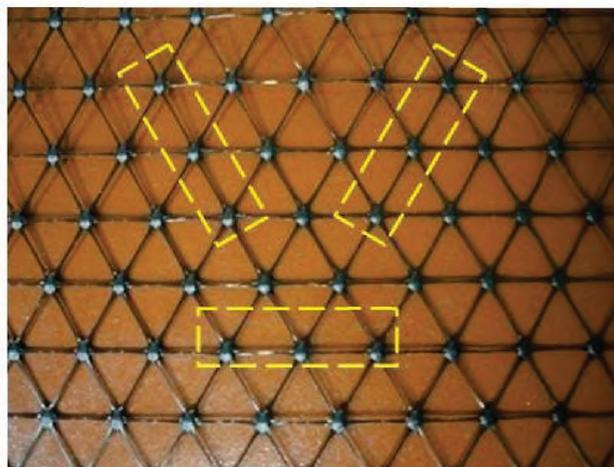
Рисунок А.2 — Схема отбора образцов для испытания на прочность ребра и прочность узла
