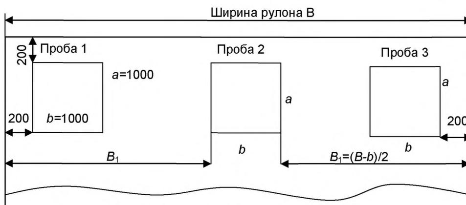
Рисунок А.3 — Схема отбора проб на полотне георешетки
