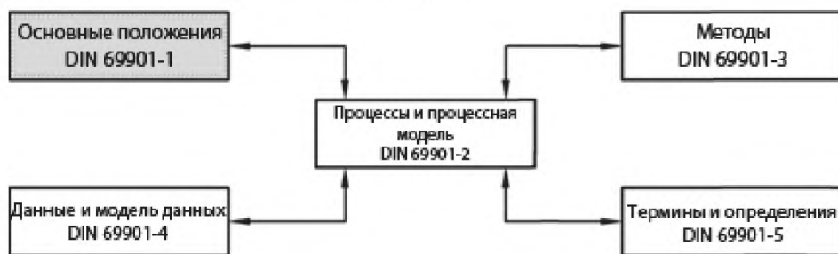
Рисунок 1 — Взаимосвязи между отдельными частями DIN 69901
