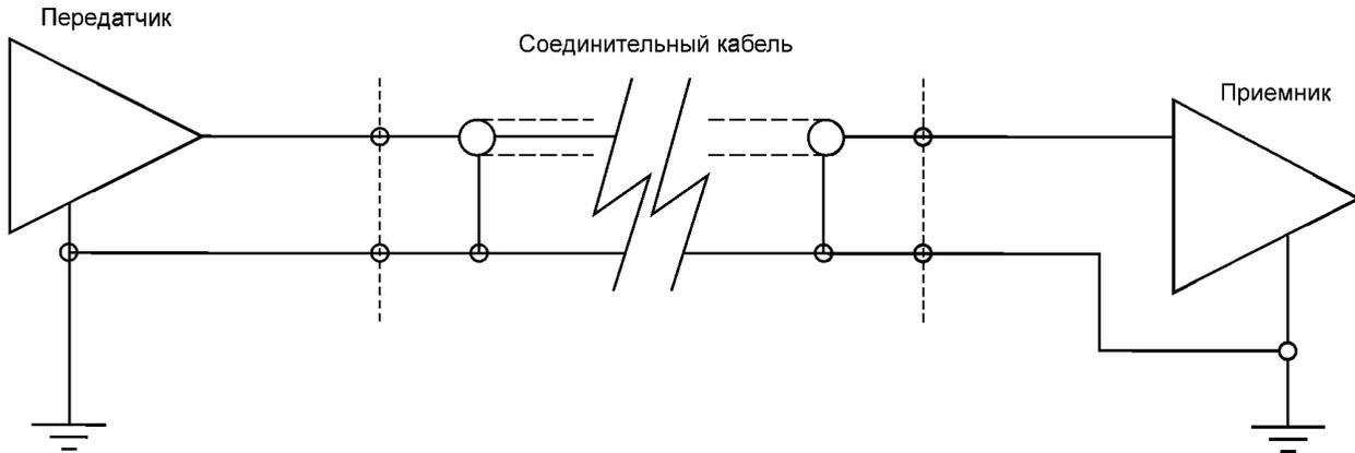
Рисунок 5 — Упрощенный пример конфигурации канала (асимметричный)
