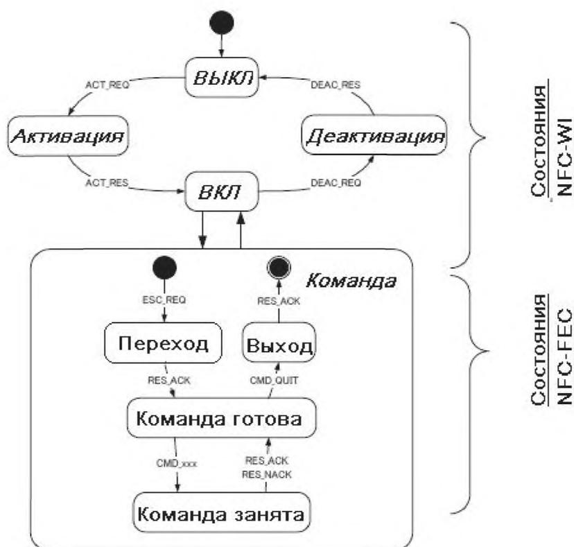
Рисунок 1 — Состояния NFC-WI и подсостояния NFC-FEC
