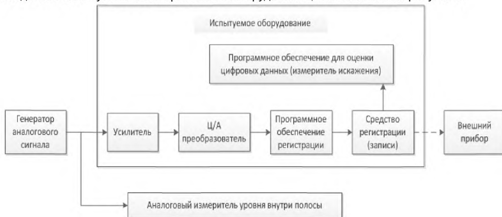
Рисунок 9 — Блок-схема для измерения максимальной допустимой амплитуды входного сигнала
