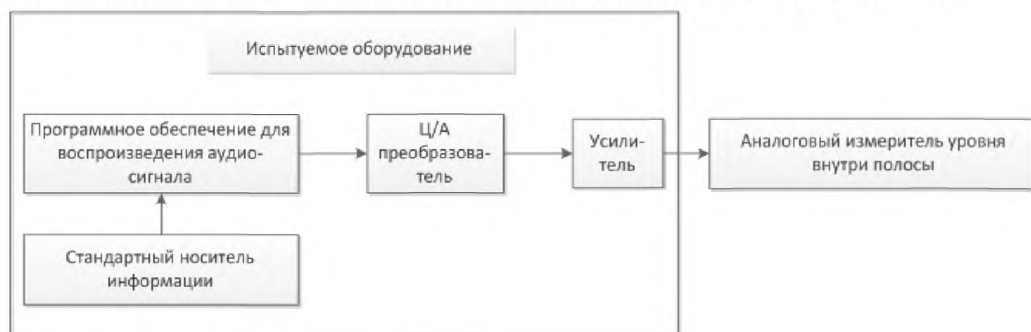
Рисунок 3 — Блок-схема для измерения амплитудно-частотных характеристик
