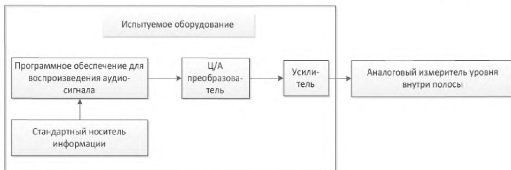
Рисунок 2 — Блок-схема для измерения разницы коэффициентов усиления между каналами
