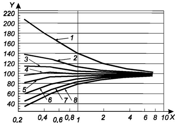
$X$  –  $\kappa$ , Вт/(м·К),  $Y$  – отклонение измерения, %
