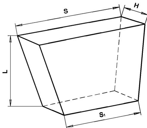
Рисунок 1 – Трапецидальный двусторонний клин
