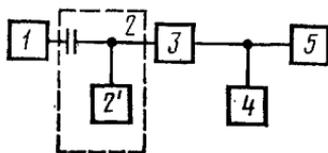
Рис. 4. Схема определения шумового сопротивления усилителя контура ПОС:
